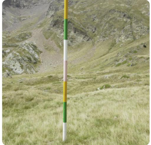
Figura 11. Pértiga para medir el espesor de nieve en invierno.
