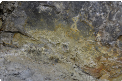
Figura 4. Detalle de las sales de azufre formadas por alteración química provocada por la humedad (izquierda). Detalle de las pizarras fácilmente erosionables que forman la base del escarpe (derecha).
