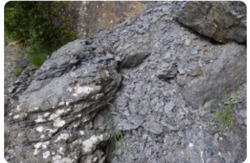
Figura 4. Detalle de las sales de azufre formadas por alteración química provocada por la humedad (izquierda). Detalle de las pizarras fácilmente erosionables que forman la base del escarpe (derecha).
